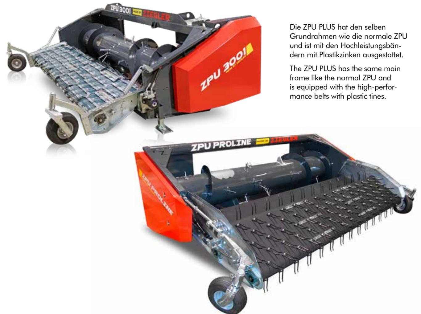
Die ZPU PLUS hat den selben Grundrahmen wie die normale ZPU und ist mit den Hochleistungsbändern mit Plastikzinken ausgestattet.
